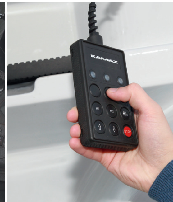
Пульт управления задней пневмоподвеской с кабины
